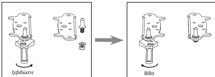
5. Τοποθετήστε εκ νέου το βραχίονα που αντιστοιχεί στον πείρο του κάτω μεντεσέ. Τοποθετήστε εκ νέου και τα δύο ρυθμιζόμενα πόδια. Μεταφέρετε την κάτω πόρτα στη σωστή θέση.
