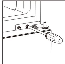
3. Τοποθετήστε το ψυγείο με την πίσω πλευρά στο δάπεδο, αφαιρέστε τα ρυθμιζόμενα πόδια όπως απεικονίζεται ακολούθως, στη συνέχεια ξεβιδώστε τον κάτω μεντεσέ με το σταυροκατσάβιδο.
